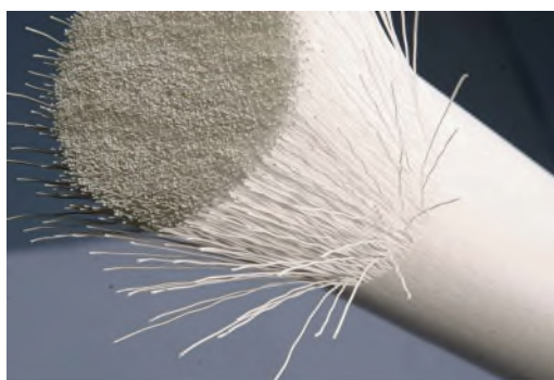
Figuur 2-6 Schematische weergave holle rietjes module (zie de webpagina Wat is een holvezelmembraan? - Leverancier van waterbehandeling ).
